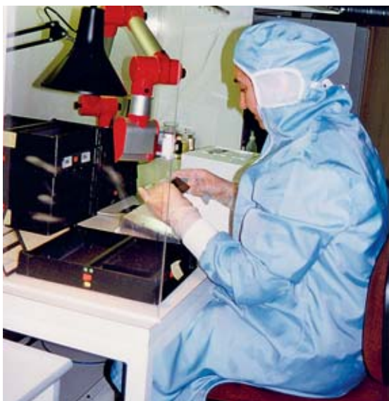
Fig. 12: in presenza di allergeni (l'immagine mostra un lavoratore che usa una resina epossidica) l'ambiente di lavoro deve essere pulito e bisogna adottare adeguate misure di protezione.
