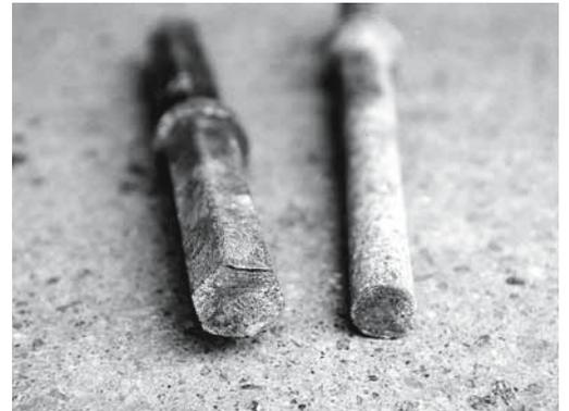
Fig. 7: a temperature estremamente basse questi ferri sono diventati talmente fragili da spezzarsi come se fossero di vetro.
