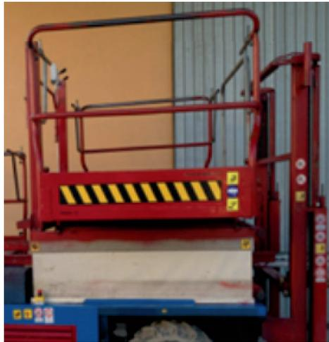
**Figura 2:** Esempio di elemento segnalante delle estensioni laterali mobili
